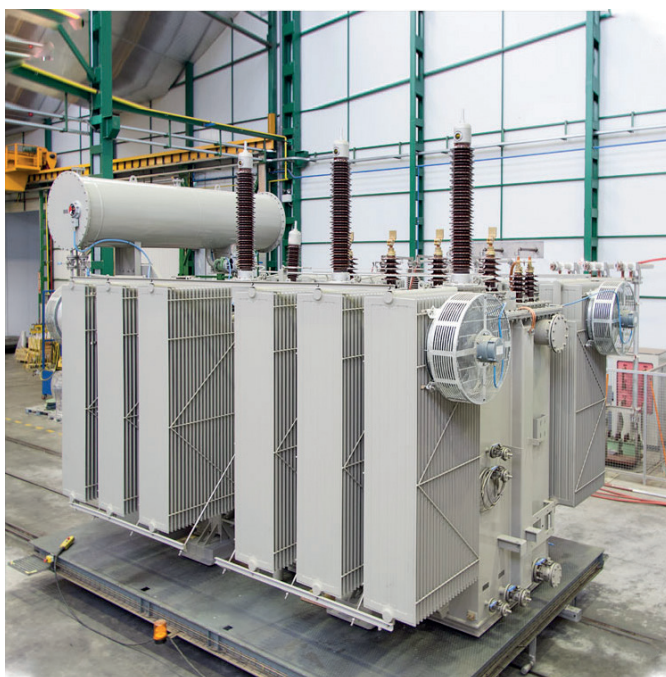
Ilustración 2.19 Transformador de potencia
