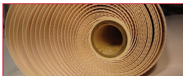
Ilustración 3.31 Módulo de membranas enrolladas en espiral.
