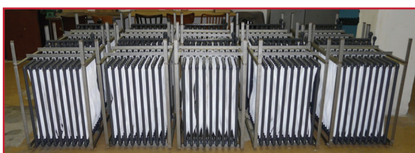
Ilustración 3.30 Módulos de membranas de fibra hueca.
