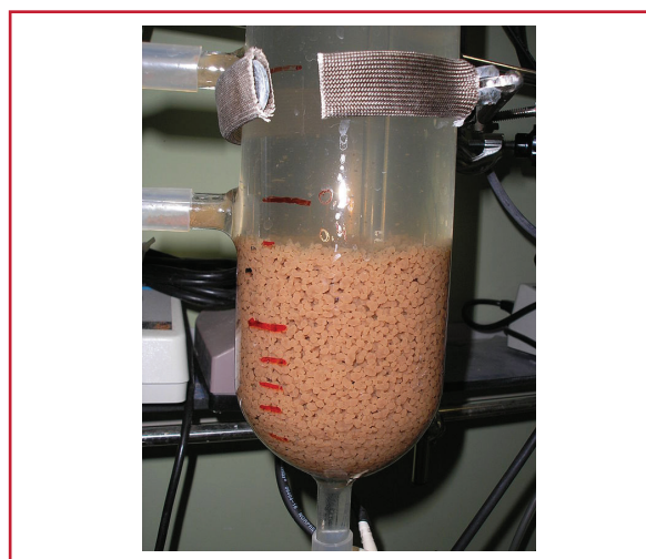
Ilustración 2.37 RDS con lodo granular
